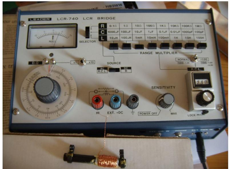
Illustration 3: Mesure de l'antenne à l'inductancemètre
