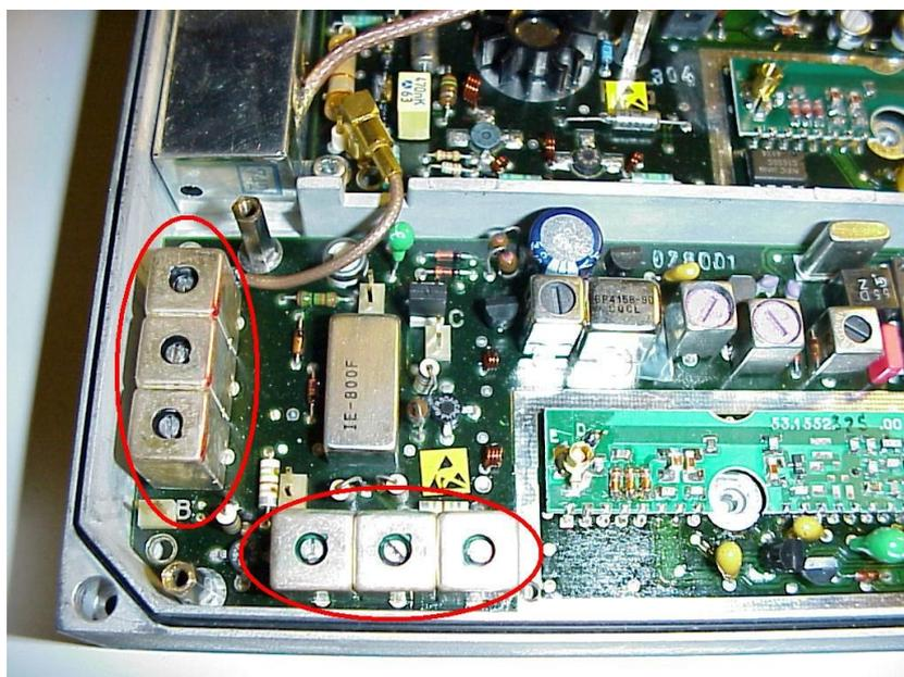
A ce moment jouez avec les 6 trimmers du filtre de réception pour diminuer le souffle au maximum. Partez de la position médiane, et faites attention à ne pas «forcer en butée » et détruire le pas de vis
