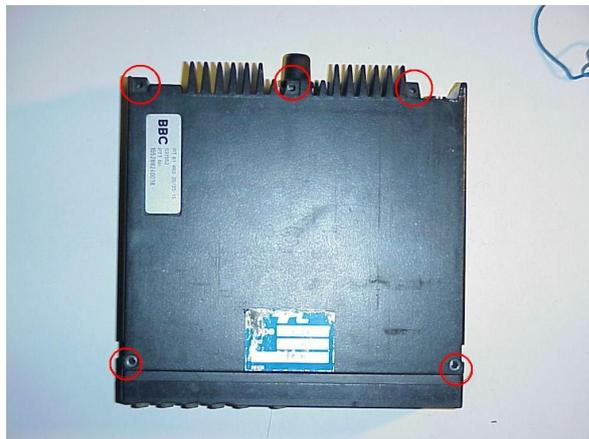
Dévissez les 5 vis (à nouveau entourées en rouge) qui retiennent le capot de blindage intérieur de la partie gauche de l'appareil, et ôtez délicatement ce capot.
